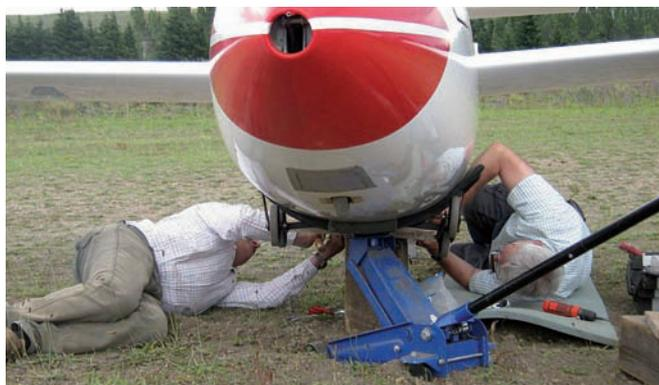
**Fig. 11 - Cambio della ruota in pista**
