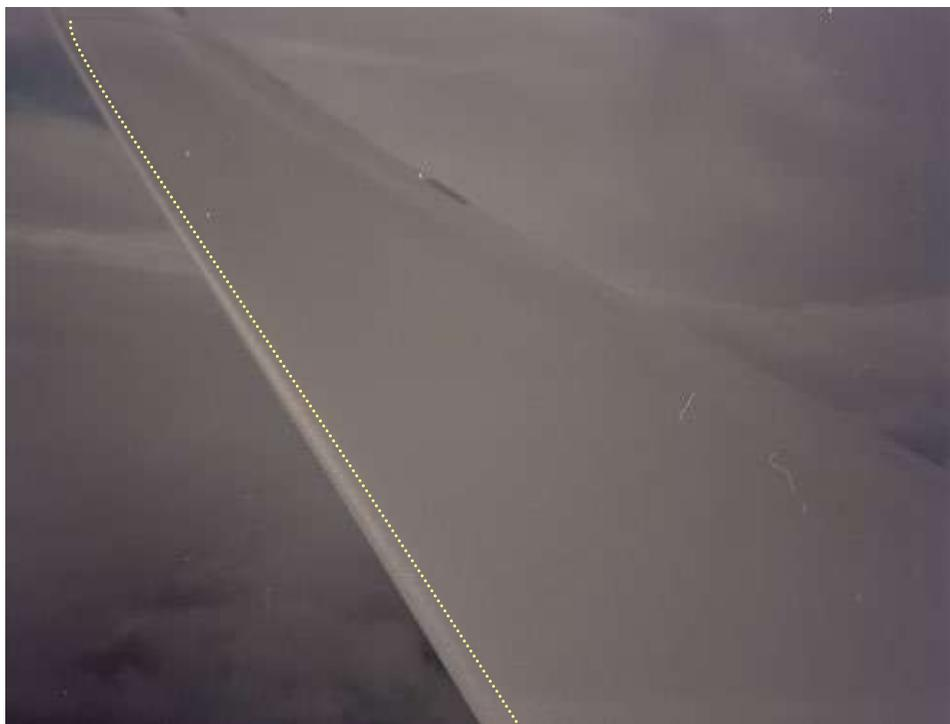
Fig. 10.5.12 Esempio di formazione di ghiaccio su un bordo d'attacco appena trattato con Teflon®, a seguito di un ingresso di aria marittima ghiacciata nell'ovest dei Pirenei. Quel giorno non era necessario entrare in nube per volare in condizioni di ghiaccio.
