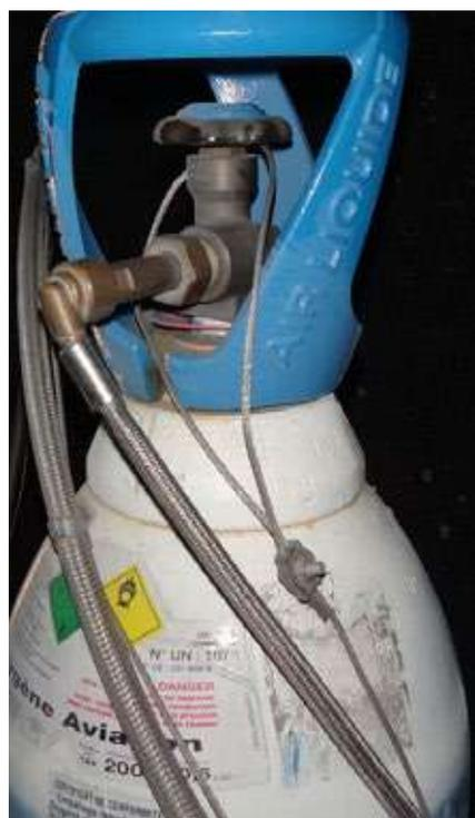
Fig. 12.4.1 Cavo di sicurezza lungo il flessibile fissato ogni 50 cm.
