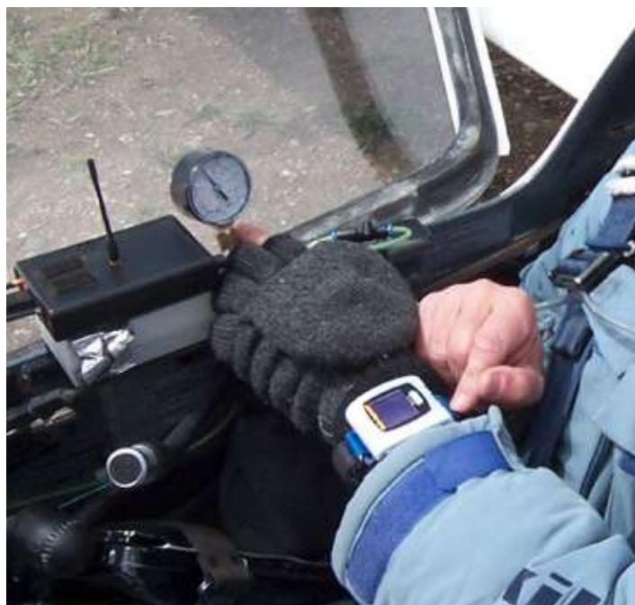
Fig. 12.6.3a montaggio temporaneo di un manometro che misura la pressione dinamica all'ingresso di un EDS. Il laboratorio volante registra tutti i parametri di volo della saturazione di ossigeno e della frequenza cardiaca, un punto ogni 4 secondi, e il pilota monitora continuamente la pressione dinamica all'ingresso dell'EDS (oltre che sul sedile anteriore).
