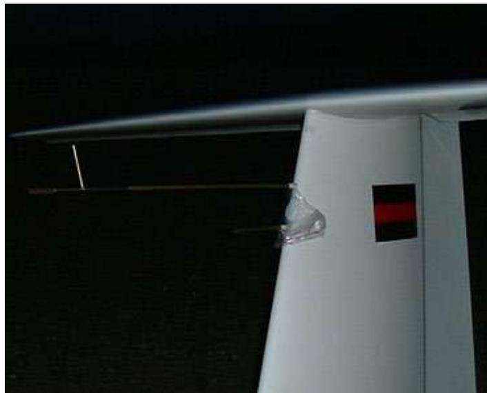
Fig. 11.2.3 Siamo stati molto fortunati, la borsa è stata forata dal tubo di Pitot, che è dotato di una trappola per liquidi. Qualche centimetro più in alto e l'antenna TE potrebbe essersi rotta, quella sarebbe stata la fine del volo.
