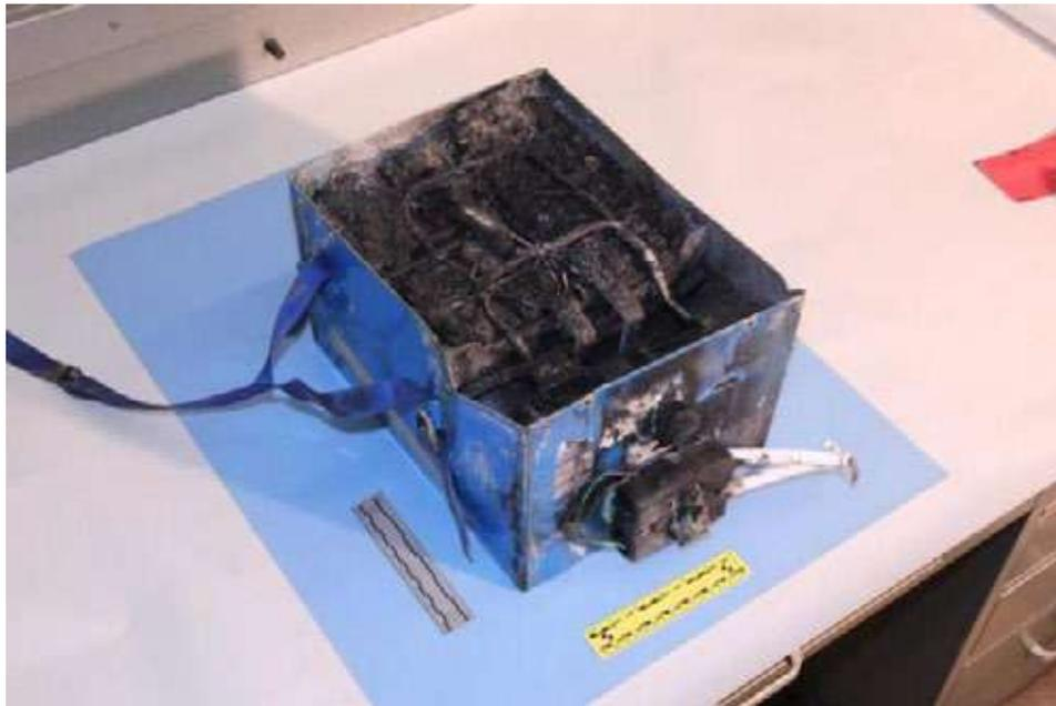
Figura 10.7.5 Una batteria agli Ioni di Litio bel B787 Dreamliner dopo un incendio.
