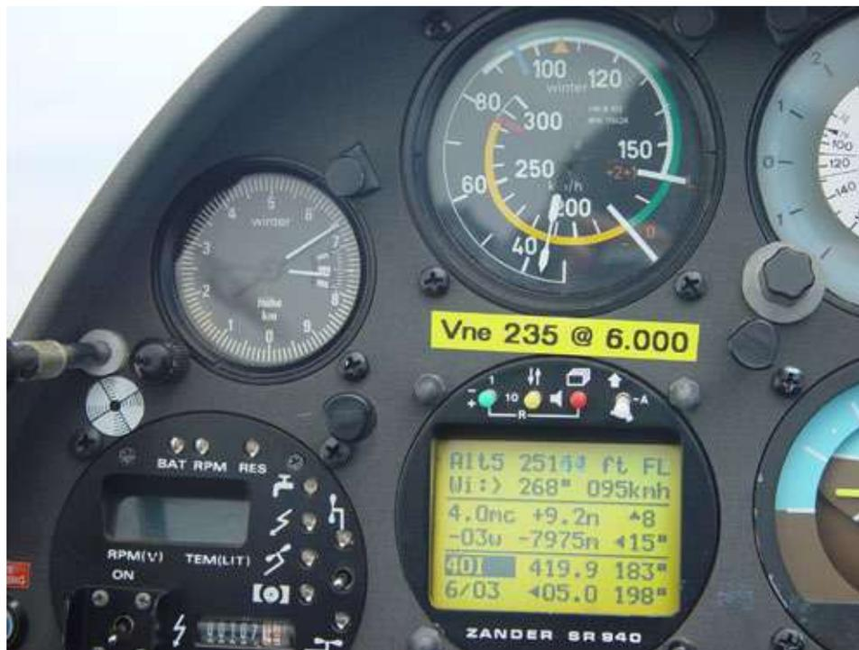
Salita di 9,2 m/s alla Vne a 7.600 m, non è più possibile accelerare ulteriormente per evitare di salire. Bisogna abbandonare deliberatamente l'ascendenza. A quel tempo non avevo ancora applicato la modifica per aumentare la Vne a 6.000 m fino a 260 km/h indicati. Insieme a Fabrice Papazian, stavo volando nel rimbalzo della Cordillera del Viento, il 13 dicembre 2003, e battemmo il record francese di distanza di 2.582 km.
