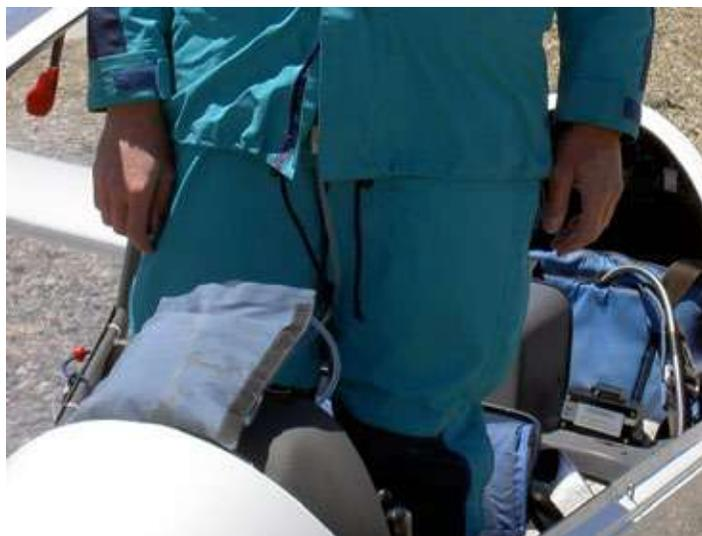
Fig. 11.2.1 Borsa collegata a un catetere esterno (preservativo urinario). Molto capacità, confortevole, ma insufficiente per un lungo volo e inutilizzabile al freddo. Soluzione abbandonata a favore del sacchetto per congelatore usa e getta.
