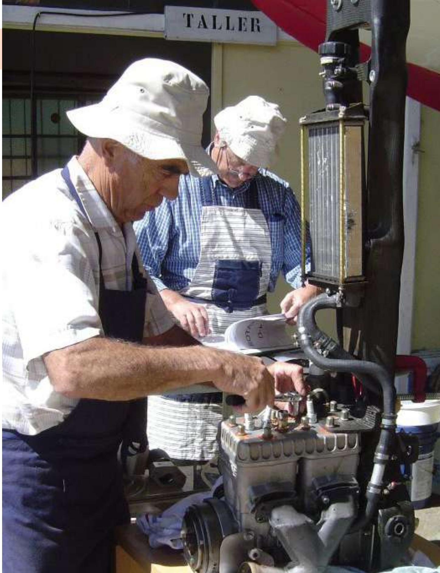
*Novembre 2004. Il motore Rotax 535 ci ha abbandonato, una fascia del pistone rotta. Per fortuna Pierre Lang (a sinistra) ci gratifica con le sue doti di meccanico svizzero di precisione, troviamo un pistone dello stesso diametro e dello stesso peso a Buenos Aires e l'aliante decollerà col suo proprio motore nove giorni dopo.*
