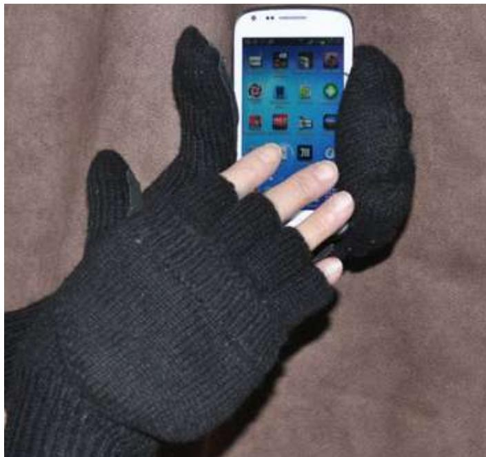
Fig. 11.2.9. La metà superiore del guanto è ripiegata per rilasciare le dita per manipolare interruttori e pulsanti o altri schermi tattili.
