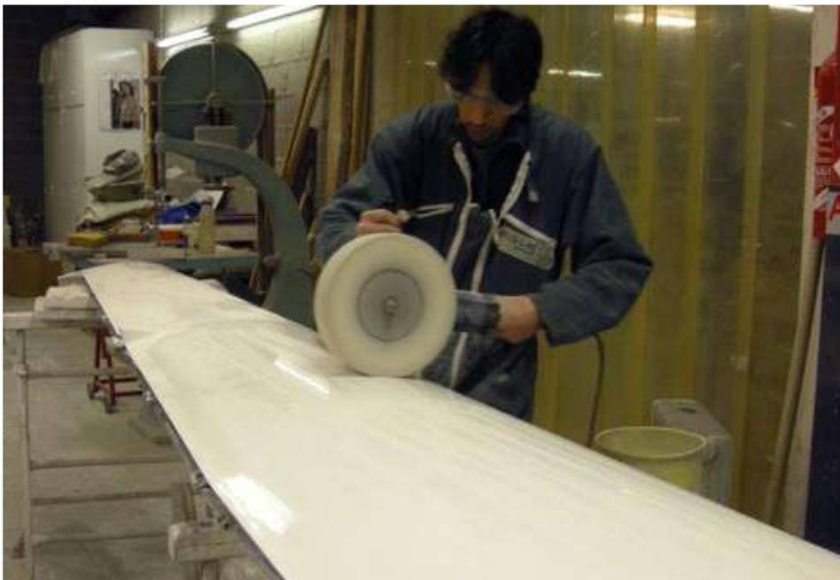
Fig. 10.6.2 Lucidatura con cera dura, operazione ripetuta almeno una volta all'anno. Il tampone viene periodicamente premuto contro un grumo di cera poi questa cera viene trasferita al gelcoat, la pressione sulla superficie deve essere un equilibrio tra la temperatura di fusione della cera e quella che non danneggi il tessuto stratificato.
