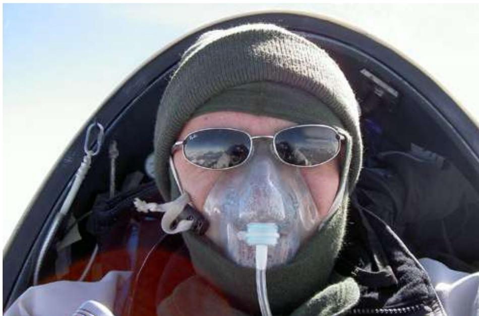
Fig. 10.5.7 La combinazione di maschera e passamontagna è assai efficace nel ridurre la quantità di vapore acqueo disperso nella cabina, ma le sue prestazioni nell'erogazione dell'ossigeno sono inferiori di almeno il 20% rispetto alle cannule nasali.
