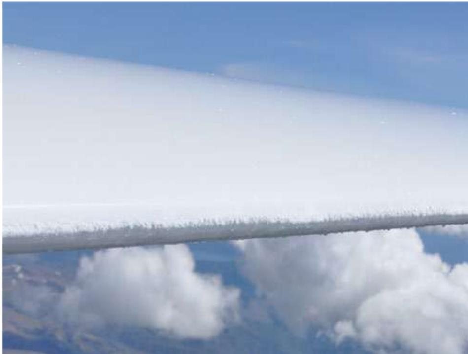
Fig. 10.5.11 Esempio di formazione di ghiaccio su un bordo d'attacco non trattato, a seguito di una rapida salita in cumulus congestus.
