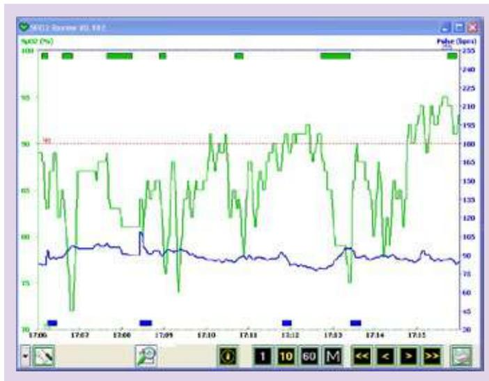
Fig. 12.7.2a Pulsogramma di un pilota per il quale la punta della cannula era troppo sottile rispetto alle dimensioni delle sue narici. Pilota 37 anni, atletico, di costituzione robusta, in perfetta salute. La situazione ipossico è ovviamente invalidante. L'altitudine variava tra 7.800 e 7.200 m.
