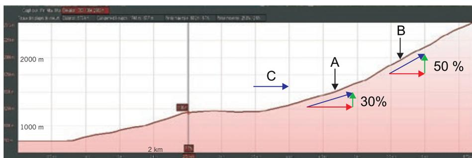
Fig. 3.1.2 Decomposizione del vento in componenti vettoriali sul versante del Monte Guillaume
