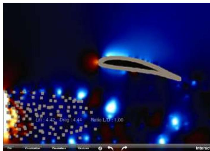
Fig. 4.8.4 Simulazione del campo di pressione in presenza di un ostacolo poroso.  $CL = 4,42$ ,  $Cx = 4,44$ ,  $L/D = 1$ . Si può chiaramente osservare lo spostamento del punto neutro verso l'estradosso con aumento della depressione sull'intradosso e notevole riduzione della portanza.
