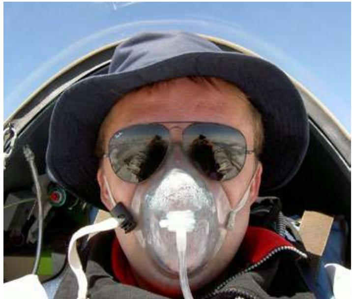
Fig. 12.7.1 Mascherina in vinile trasparente, fornitura standard di Mountain High. Inefficiente, spreca l'ossigeno, evitarne l'uso.
