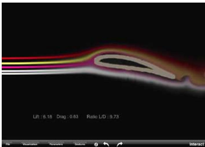
Fig.4.8.1 Il flusso in assenza di ostacoli è regolare.  $Cl = 6,18$ ,  $Cx = 0,63$ ,  $L/D = 9,73$ .
