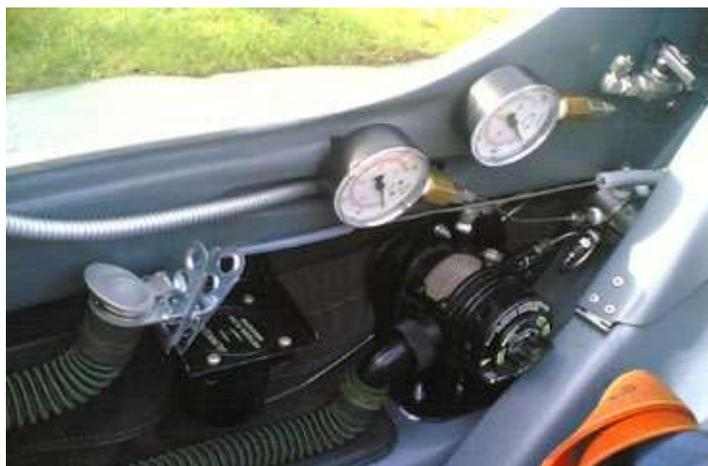
Fig. 12.3.3 Regolatore US «a richiesta di pressione» A-14. A sinistra, di una monoposto «Nimbus». A destra, sedile posteriore di un biposto ASH25.
