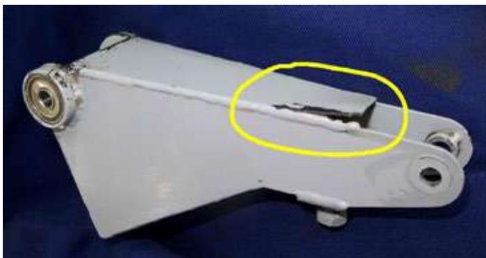
Fig. 10.2.3B. Particolare della parte dopo smontaggio e pulizia.
