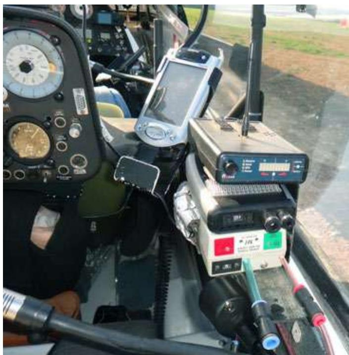
Fig. 12.6.6 Installazione di un EDS D1 in servizio e uno EDS O2D1 in riserva.
