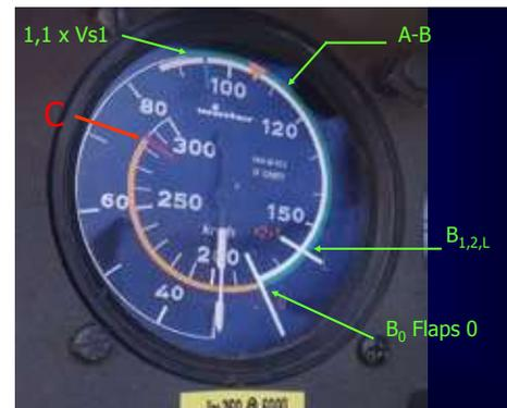
Fig. 9.9.2 anemometro Nimbus 4DM, corrispondenza dei limiti strutturali.
