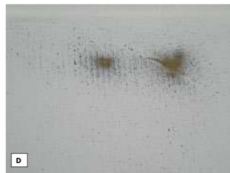
Fig. 10.6.3 Esempi di crepe dovute all'umidità e alla temperatura su diversi tipi di gelcoat.
