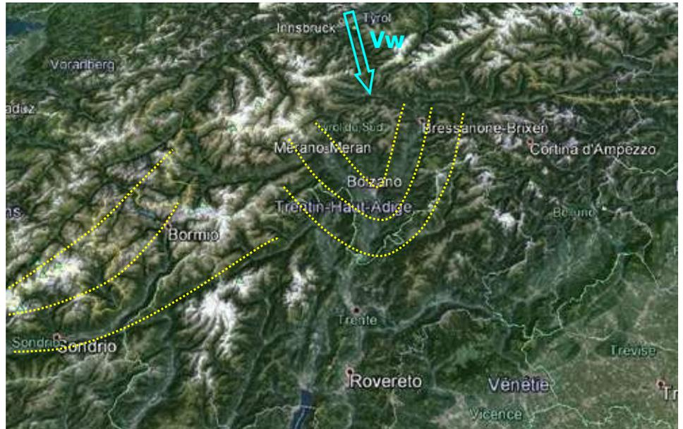
8.5.3 L'immagine satellitare precedente sovrapposta a un'immagine satellitare delle montagne. Possiamo vedere come la forma di ogni cresta e valle si riflette sotto forma di nuvole d'onda, anche oltre i  $45^\circ$  di differenza tra la vetta e la perpendicolare al vento.
