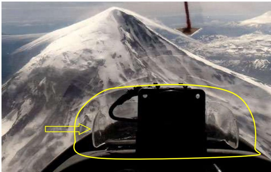
Fig. 10.5.6 deflettore altamente efficace montato su Nimbus 4 e trattenuto da una striscia di Dual Lock, facilmente removibile durante il volo.
